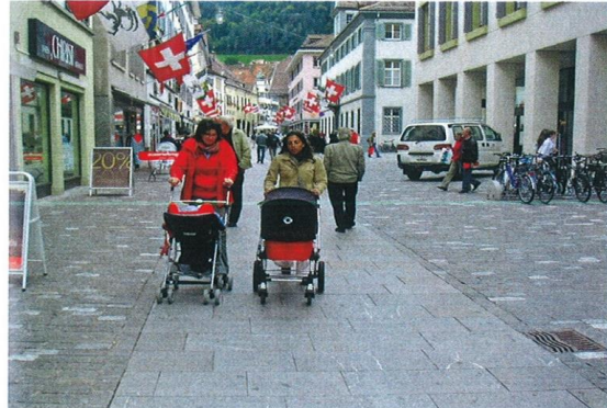
Abb. 2.20: Berollbare Fahrgasse zwischen Natursteinen in Chur (Quelle: Hessen Mobil Straßen- und Verkehrsmanagement)
